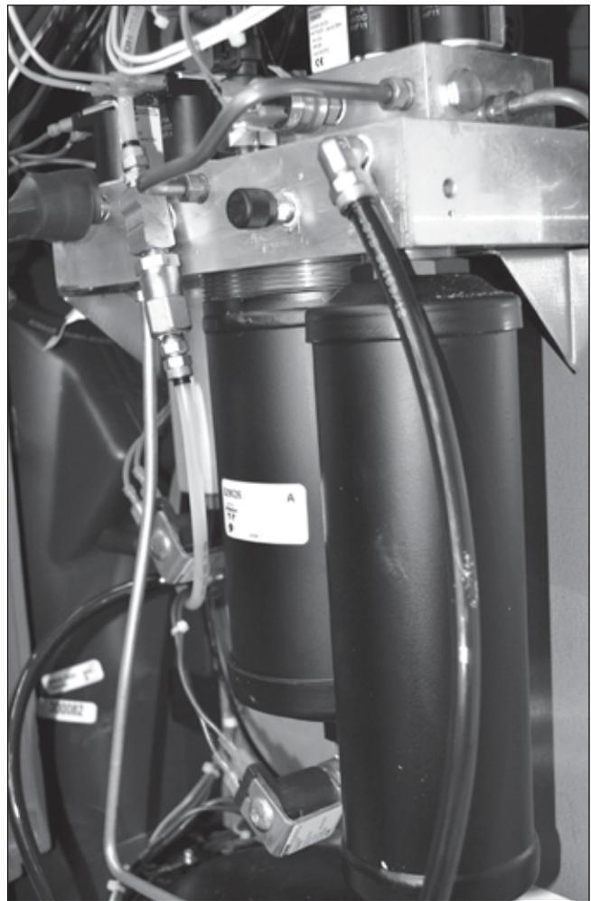
Los filtros/secadores de la máquina de R/R/R se deben reemplazar de acuerdo con las recomendaciones del fabricante de la máquina.
