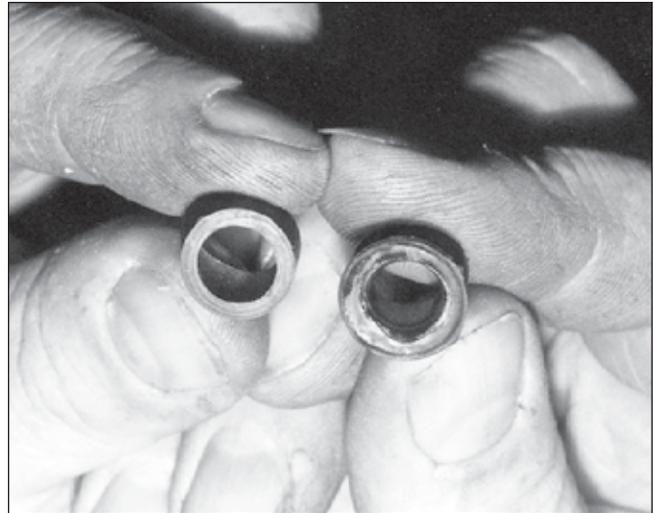
Los sellos en las mangueras del equipo de servicio deben ser revisados con frecuencia para ver si existen daños y sean reemplazados cuando sea necesario. Aquí se muestra una comparación entre un sello nuevo (a la izquierda) y uno usado inflamado y distorsionado (derecha).
