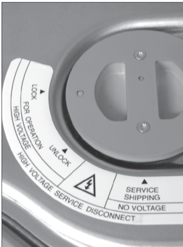
Este es un ejemplo de un dispositivo de desconexión del alto voltaje en un vehículo híbrido. Cuando trabaje en cualquier vehículo híbrido o eléctrico, SIEMPRE siga los procedimientos de seguridad recomendados por el fabricante.
