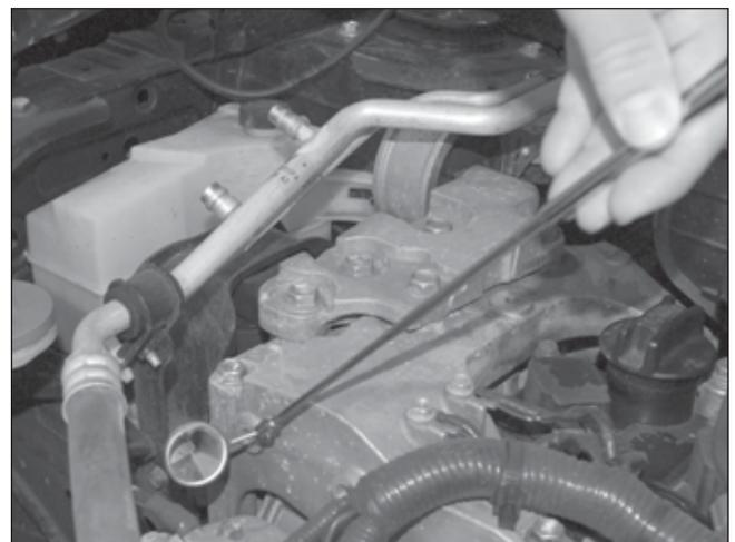
*En algunos lugares difíciles de ver, usted puede utilizar un espejo para reflejar la luz UV por debajo de los componentes. Si la fuga está presente en el lugar, usted la verá como brilla en el espejo.*
