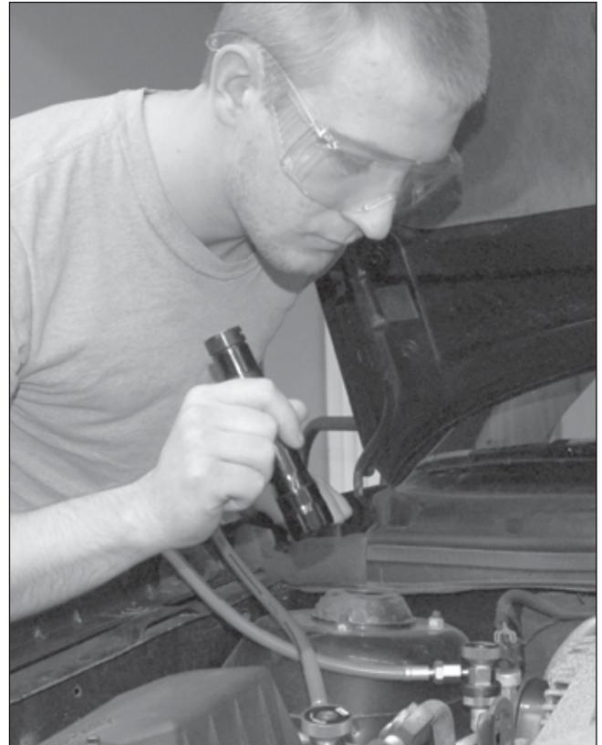
*Al igual que este técnico, siempre asegúrese de usar las gafas especiales que se incluyen con el juego de detección de fugas con tinte UV. No sólo protegen sus ojos de la luz UV, también dejan rastros de colorante en los lugares con fugas y se destacan mejor.*
