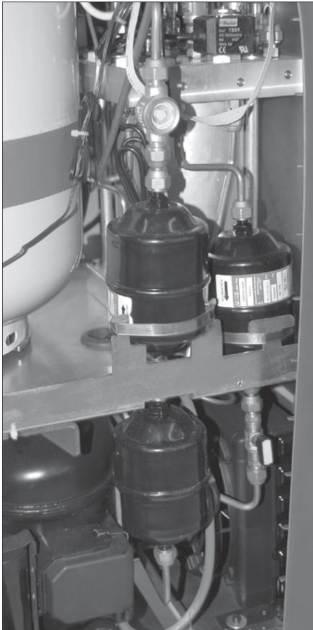
La tubería interna de la máquina de R/R/R se debe revisar periódicamente para cerciorarse que no hay fugas presentes.
