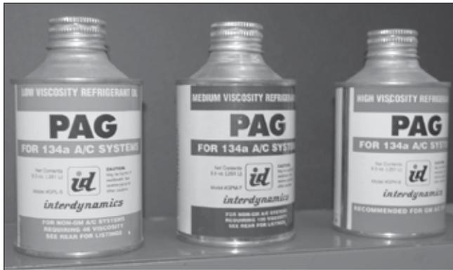
Los diferentes sistemas de HFC-134a requieren del uso de diferentes aceites. Usted debe instalar el tipo y la viscosidad recomendadas por el fabricante del sistema o del compresor. Para saber el tipo que usted necesita usar, refiérase a la etiqueta de información del sistema de A/C debajo del cofre, o busque el tipo en un manual de servicio o en un sistema de información electrónica.
