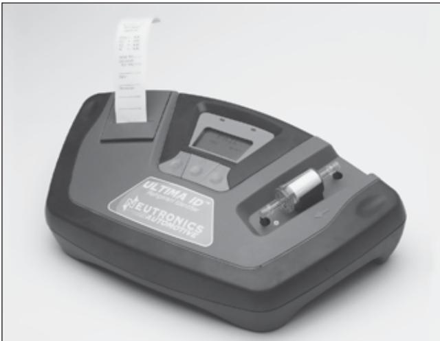
*Mientras que no es requerido por la ley federal, el uso de un identificador de refrigerantes es muy recomendado. Puede ayudarle a determinar si un vehículo contiene refrigerante contaminado que usted no desea dentro de su máquina de recuperación. Los identificadores pueden también proporcionar una indicación exacta referente a la cantidad de aire que puede estar en un tanque de almacenaje o en el sistema de A/C. Algunas leyes locales y estatales requieren de su uso.*
