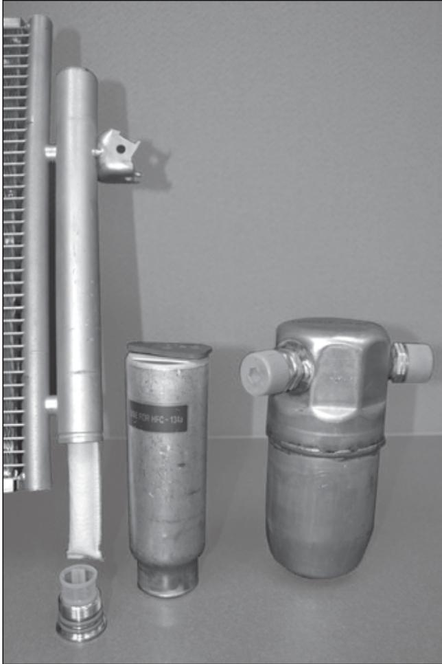
La única manera definitiva de eliminar la humedad de un sistema es reemplazando el desecante. No sólo eso, las garantías de la mayoría de los proveedores de compresores requieren que el R/D, A/D, o desecante sean reemplazados cuando se instala uno de sus compresores.
