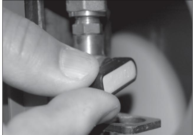
Usted puede utilizar la válvula de purga de aire de la máquina de R/R/R para purgar el exceso de aire del refrigerante reciclado. Deje salir el aire, y vea el indicador de presión en el panel de la máquina. Cuando la lectura del indicador alcance el número apropiado en la tabla (basado en la temperatura ambiente), cierre la válvula de purga. Ahora el refrigerante reciclado no tendrá una cantidad excesiva de aire, y se podrá reutilizar para recargar un sistema de A/C.
