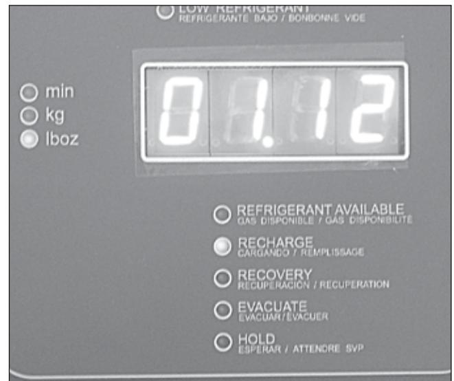
*Esta máquina muestra la cantidad de carga de refrigerante en libras y onzas. Sin embargo, la etiqueta en cada vehículo no muestra la especificación de esta manera, por lo que será necesario hacer cálculos; un lugar fácil para cometer un error. (Algunas máquinas permiten cambiar las unidades de la pantalla, pero ¿cuántos técnicos lo hacen cada vez que pueden o deben?).*
